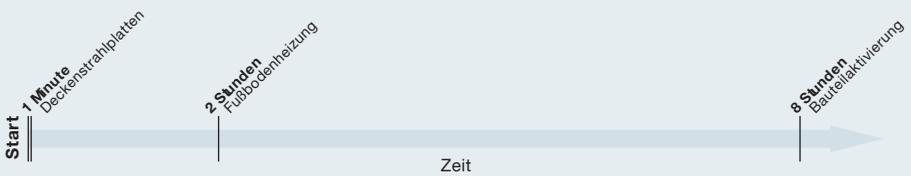
**Ergebnis:** Die Deckenstrahlplatte hat die gewünschte Oberflächentemperatur bereits nach 1 Minute erreicht und weist somit die schnellste Reaktionszeit und Regelfähigkeit auf Temperaturveränderungen auf.
