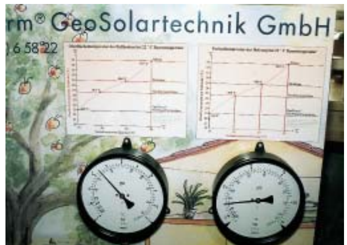
Erdwärme-Fußbodenheizung mit R 407C. Während in einem Steinhaus zum Erzielen einer Raumtemperatur von 22 °C eine Vorlauftemperatur der Heizung von 40 °C und eine Oberflächentemperatur des Fußbodens von 29,0 °C benötigt wird, genügen im Niedrigstenergiehaus 35 °C/23,0 °C
